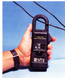
Figura 7.13: Amperímetro tipo alicate.
